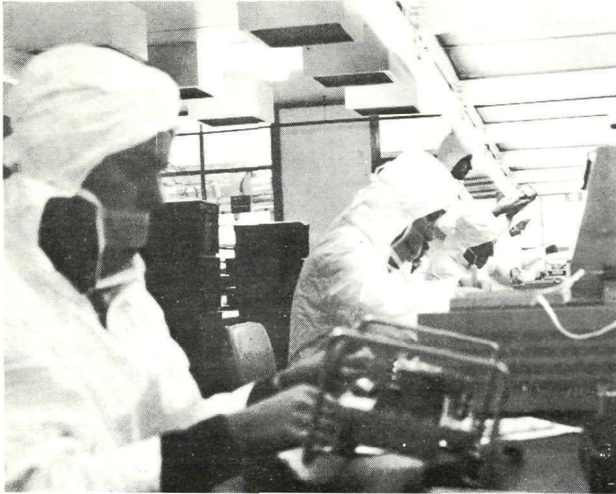
Olivetti Peripheral Equipment. Stabilimento di San Bernardo di Ivrea. Interno della «camera bianca» dove, in ambiente completamente depolverizzato, ha luogo il montaggio della coppa dei dischi rigidi utilizzati nelle memorie magnetiche degli elaboratori.
