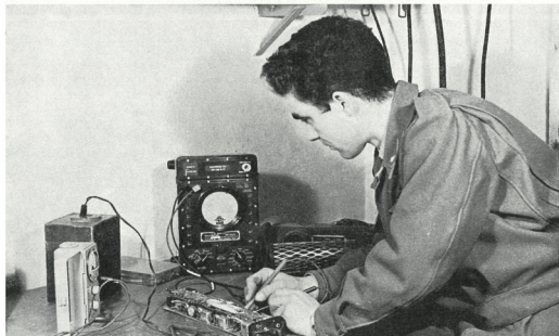
Soldato specializzato radio montatore che controlla una stazione R/536.
